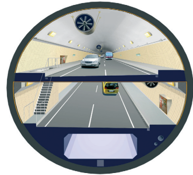
Karayolu Tüp Tünel Kesiti
