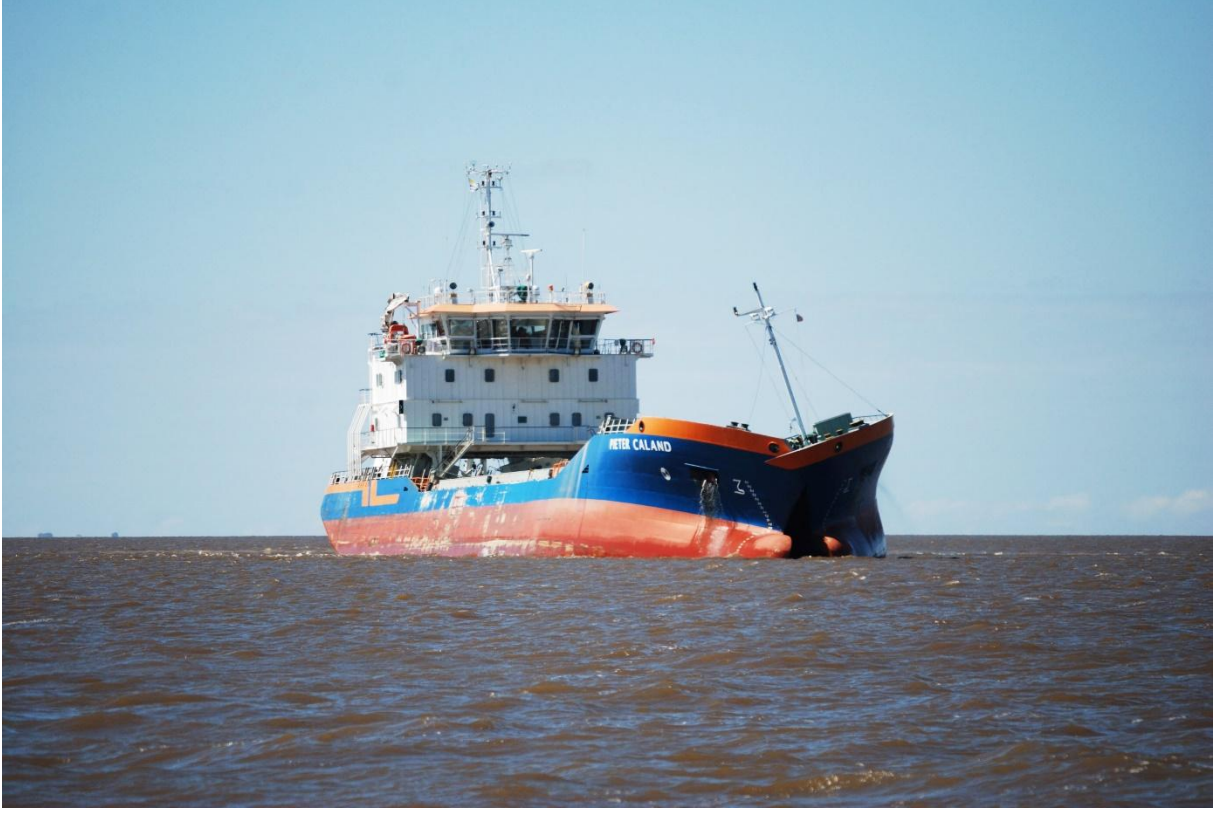
Şekil 2.10. Bölünmüş hazneli barç (split hopper barge)
