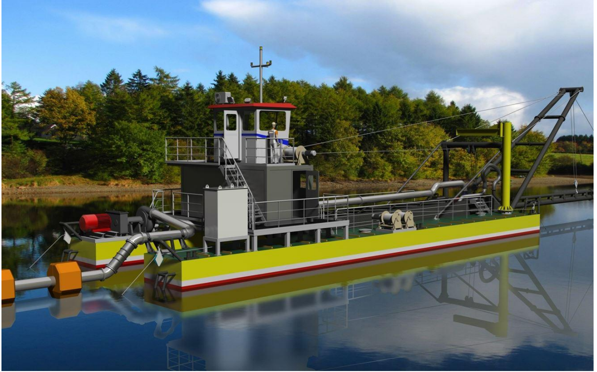
Şekil 2.6. Düz emici tarayıcı (plain suction dredger)
