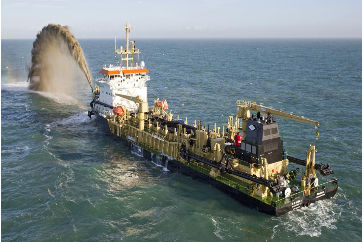
Şekil 2.9. Emici-hazneli tarama vasıtası (trailing suction hopper dredger)
