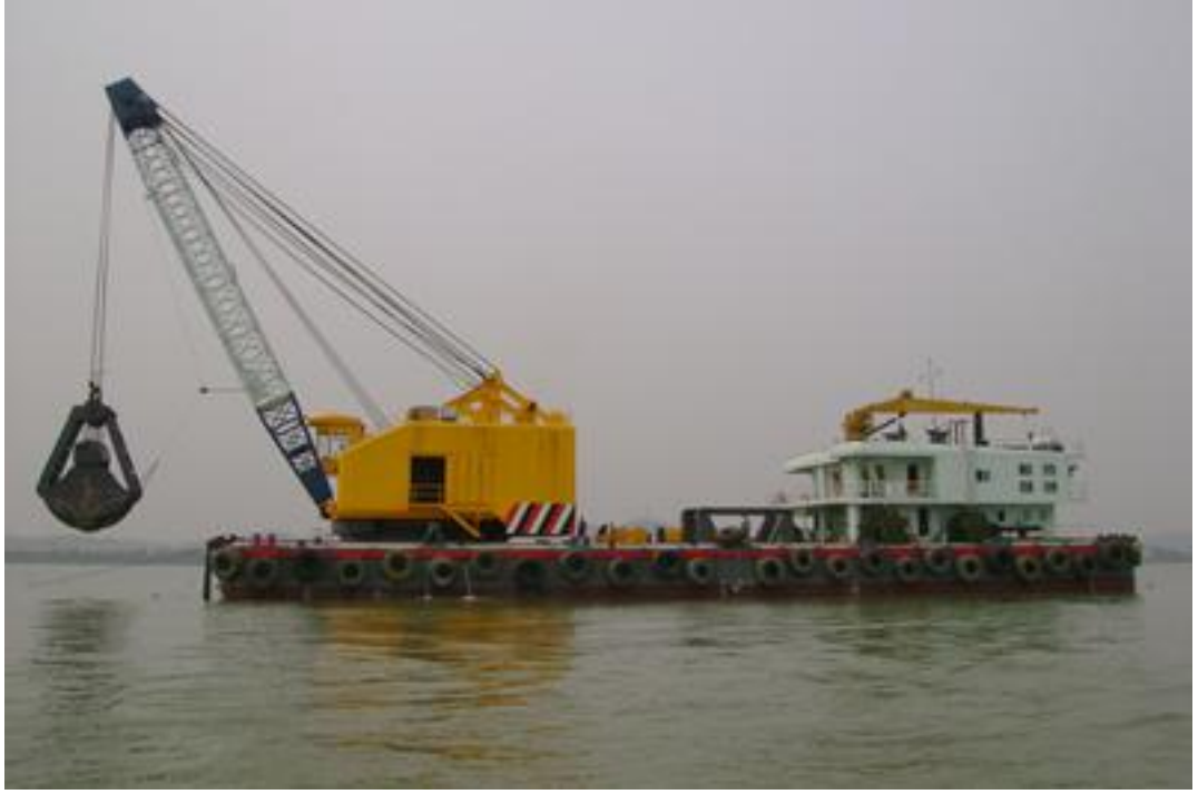
Şekil 2.3. Kapmalı tarama gemisi-aracı (yüzer vinç)
