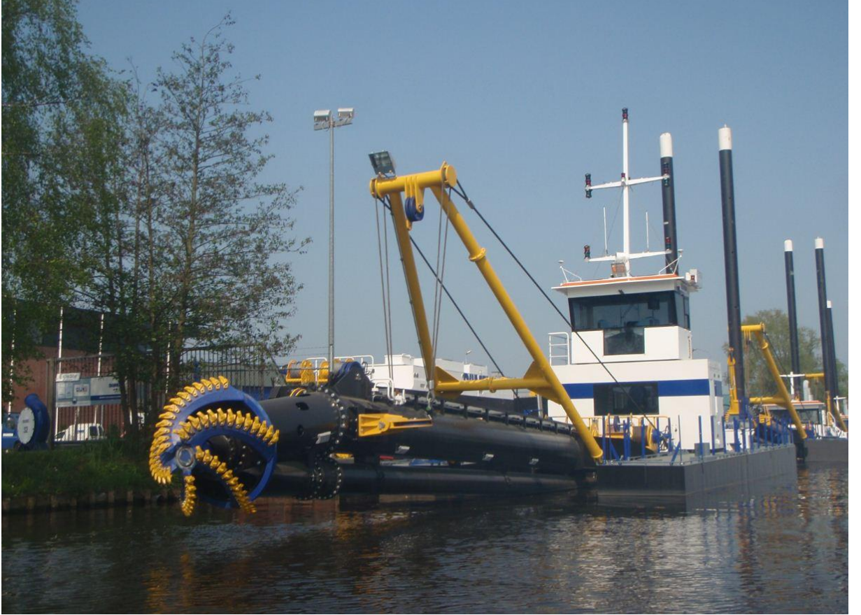
Şekil 2.7. Kesici-emici tarama vasıtası (cutter-suction dredger)
