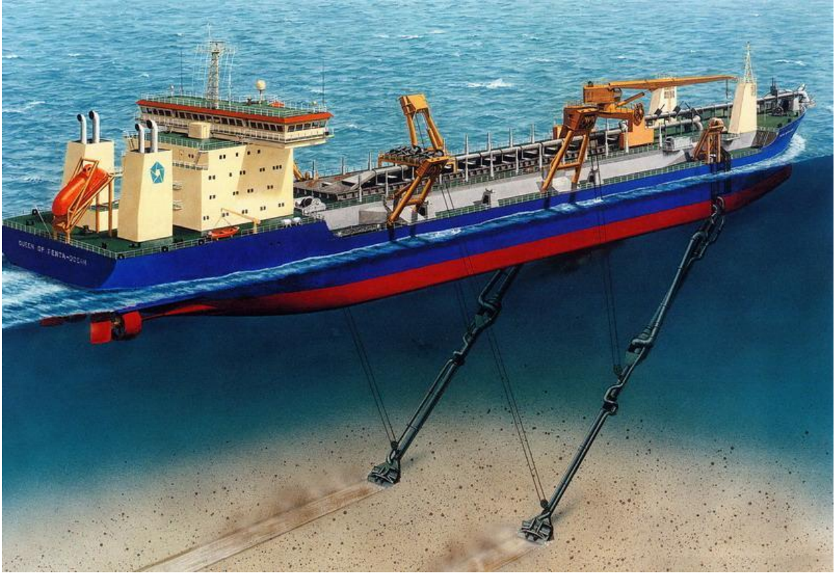
Şekil 2.8. Emici-hazneli tarama vasıtası (trailing suction hopper dredger)
