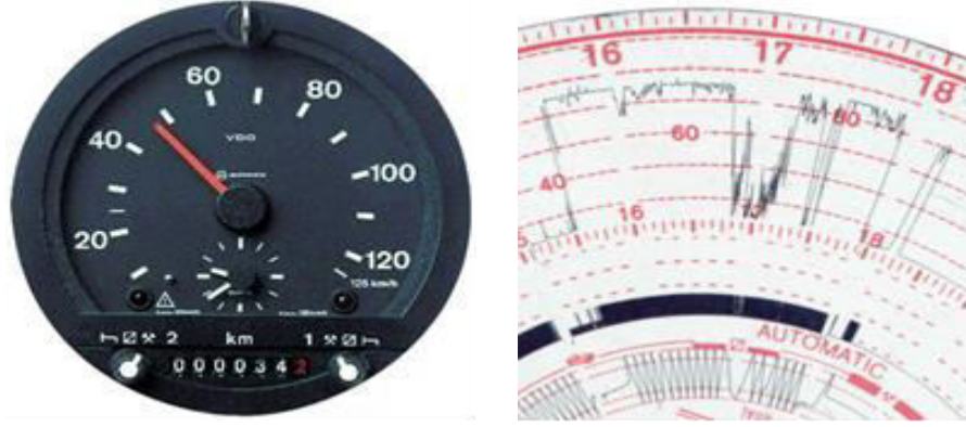
Şekil 2.1 Kilometre sayacına bütünleşmiş analog takograf cihazı ve bilgilerin kaydedildiği kağıt disk
