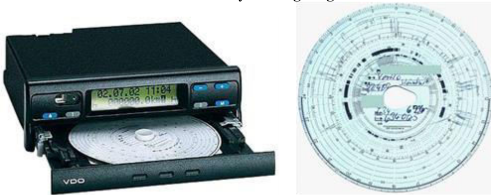
Şekil 2.2 Kilometre sayacından bağımsız olarak çalışan analog takograf ve bilgilerin kaydedildiği kağıt disk
