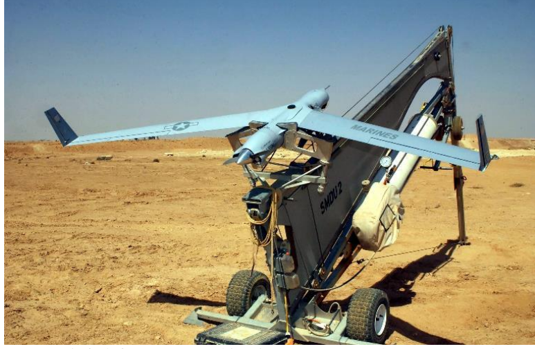
Şekil 9: İHA'nın katapulttan fırlatılması
